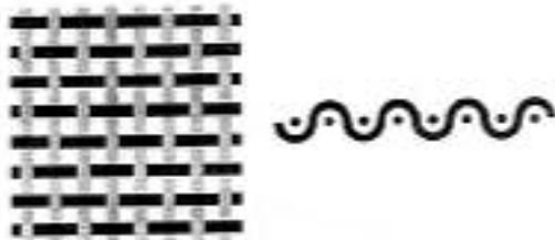
Fig 11 : Tissu toile (Twintex® pre oriented 4-1, 935 g/m 2 , 60 %).
