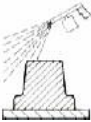
Fig. 2 : Moule composite : Principe de fabrication d'une matrice.
