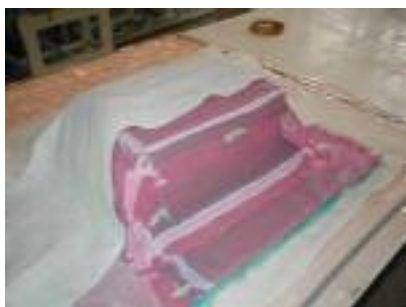
Préparation de la bâche à vide. Preparation of the vacuum bag.
