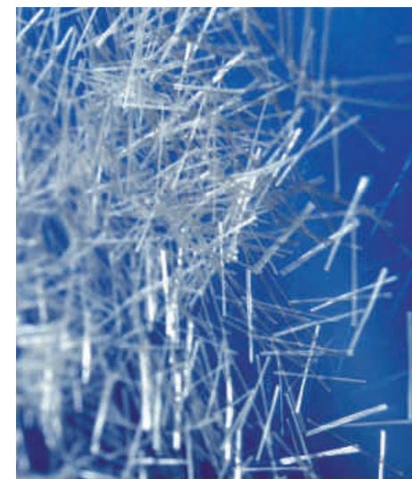
El vidrio resistente a entornos alcalinos de OCV Reinforcements se utiliza en el concreto reforzado con fibra de vidrio
