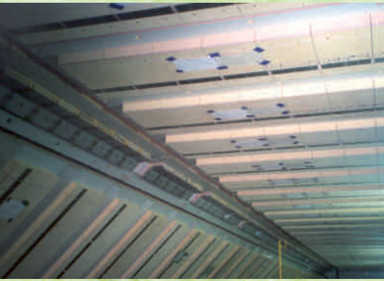
Los materiales para los buques cisterna de GNL mantienen el producto frío y poseen la resistencia a la tracción y la compresión necesaria para la aplicación en buques.
