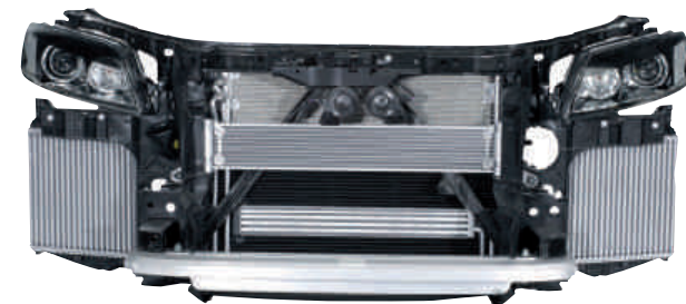
El frente del Audi Q7 está hecho con pellets de fibras largas TWINTEX® de OCV Reinforcements (Plastic Omnium Auto Exterior, Francia)
