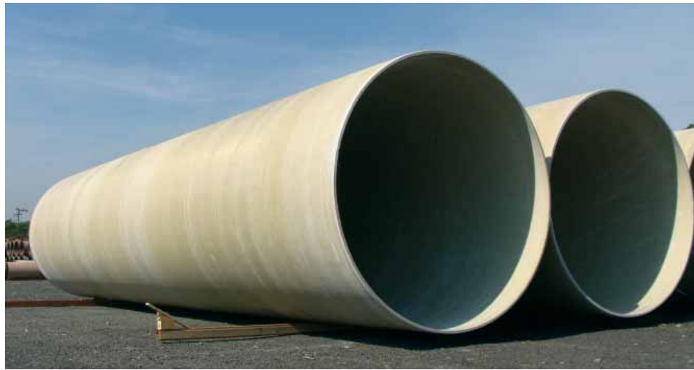
Amitech(브라질)는 필라멘트 와인딩 및 원심 주조 공법을 사용하여 파이프를 제작합니다.
