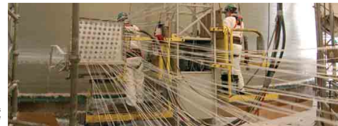
Ershigs (EE. UU.) ha producido recipientes de FRP de filamento bobinado de 88 pies de diámetro y 75 pies de altura (26,8 x 22,9 metros).
